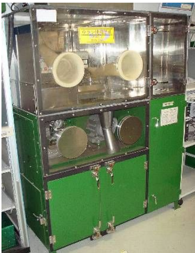
写真1 粉末取扱ボックス No.2 の外観写真
