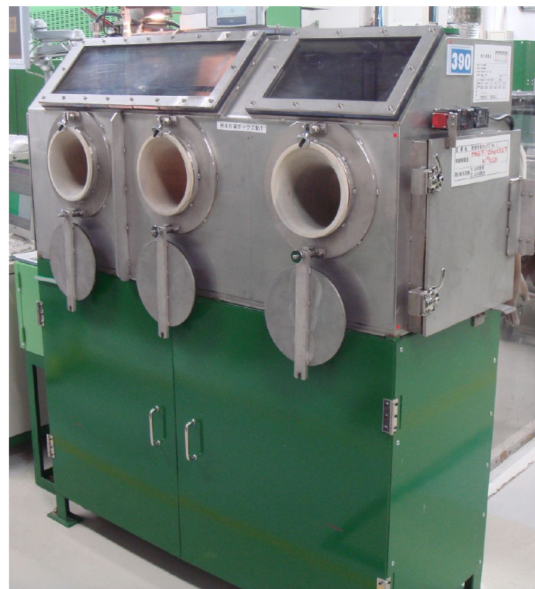
写真2 粉末作業ボックス No.1 の外観写真
