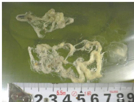
添付資料 11-写真 3 （受けタンク内から採取した剥離繊維）
